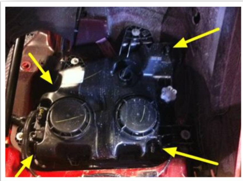
Emplacement des filtres de ventilation
