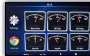
De multiples jauges virtuelles procurent de l'information réelle sur l'opération du camion. Les données relatives à la température de l'huile, la température de la transmission, la suralimentation du manifold, l'économie de carburant actuelle et moyenne, le statut du DPF (filtre au diesel contre les matières en suspension) et le couple du moteur sont préenregistrés
