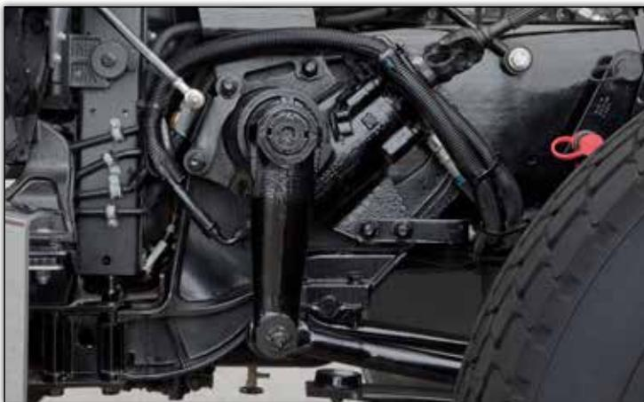
Un nouveau design en biais de la direction procure jusqu'à 9 degrés supplémentaires de braquage des roues. Ceci permet un rayon de braquage plus serré, pour une manoeuvrabilité supérieure sur le chantier.
