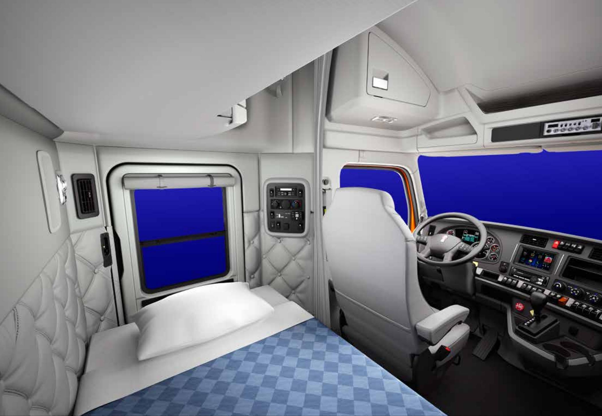
Les équipements comprennent des crochets dissimulés pour suspendre les vêtements, deux haut-parleurs, un support optionnel pour recevoir un téléviseur grand écran, un éclairage abondant, un matelas de 82,3 ou 96,5 cm et du rangement supplémentaire là où vous en avez besoin. Le panneau de contrôle séparé du compartiment-couchette gère le système audio ainsi que le chauffage/la climatisation. Un lit escamotable est standard tout autant que l'accès intérieur au coffre à outils.
