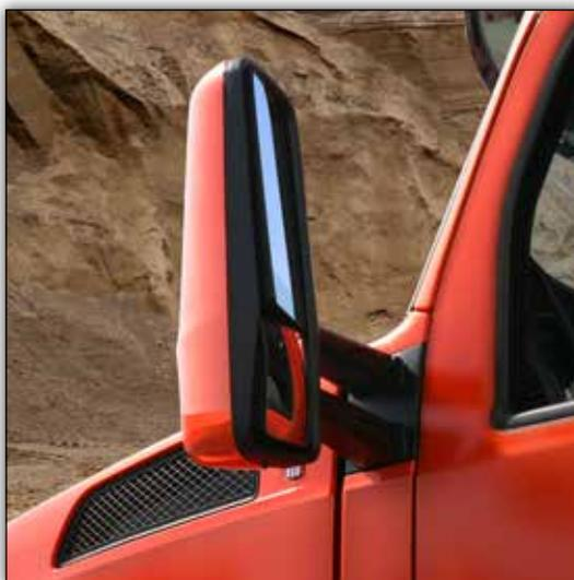
Les robustes rétroviseurs latéraux aérodynamiques sont montés sur l'avant pour une meilleure stabilité et placés plus en avant et plus bas afin d'optimiser la visibilité vers l'arrière. La partie convexe est plus grande de 37% que le design convexe standard de Kenworth.
