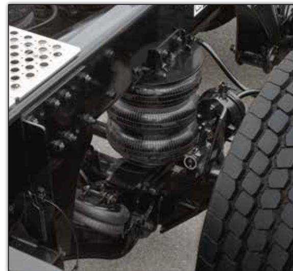
Le T880 est disponible dans cinq nouvelles configurations d'essieux escamotables Watson Chalin, incluant un nouvel essieu escamotable de 4 536 kg et un essieu escamotable reconfiguré de 9 072 kg qui réduit de plus de 90,7 kg le design de l'ancien essieu de 9 072 kg.
