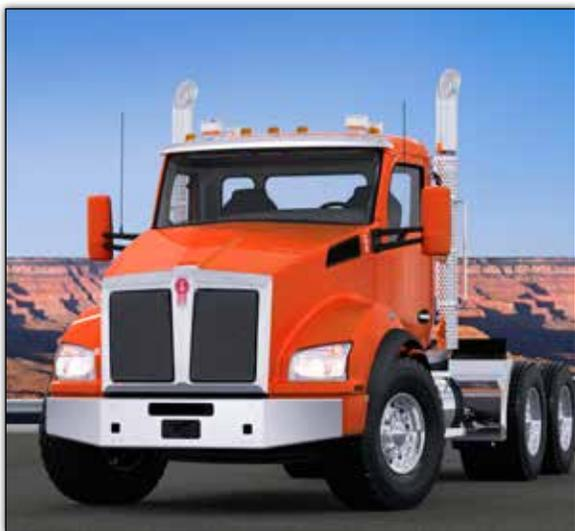
Les spécifications du T880 peuvent être établies avec le système d'échappement de votre choix : simple ou double monté verticalement sur la cabine ou encore une conception horizontale unique qui réserve l'espace derrière la cabine pour de l'équipement supplémentaire, un accès plus facile et des carrosseries allongées.
