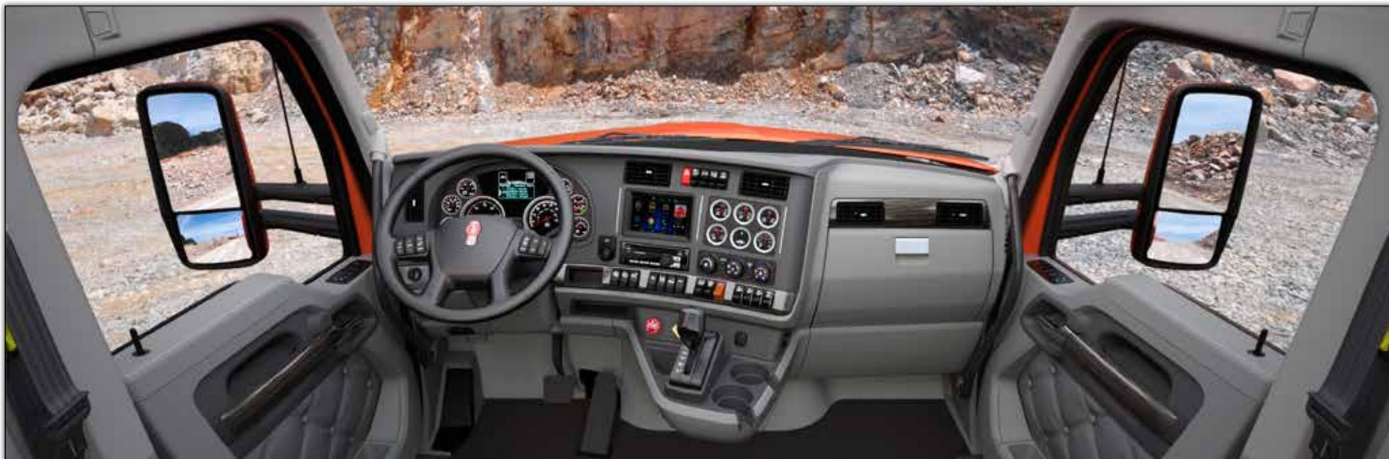
Le T880 a été conçu pour offrir une visibilité maximale en toutes situations : Un pare-brise panoramique monopièce jumelé à des portières DayLite® de signature Kenworth, des rétroviseurs chauffants ajustables, un capot à pente dramatique ainsi qu'un tableau de bord incliné afin d'élargir considérablement le champ de vision du chauffeur.
