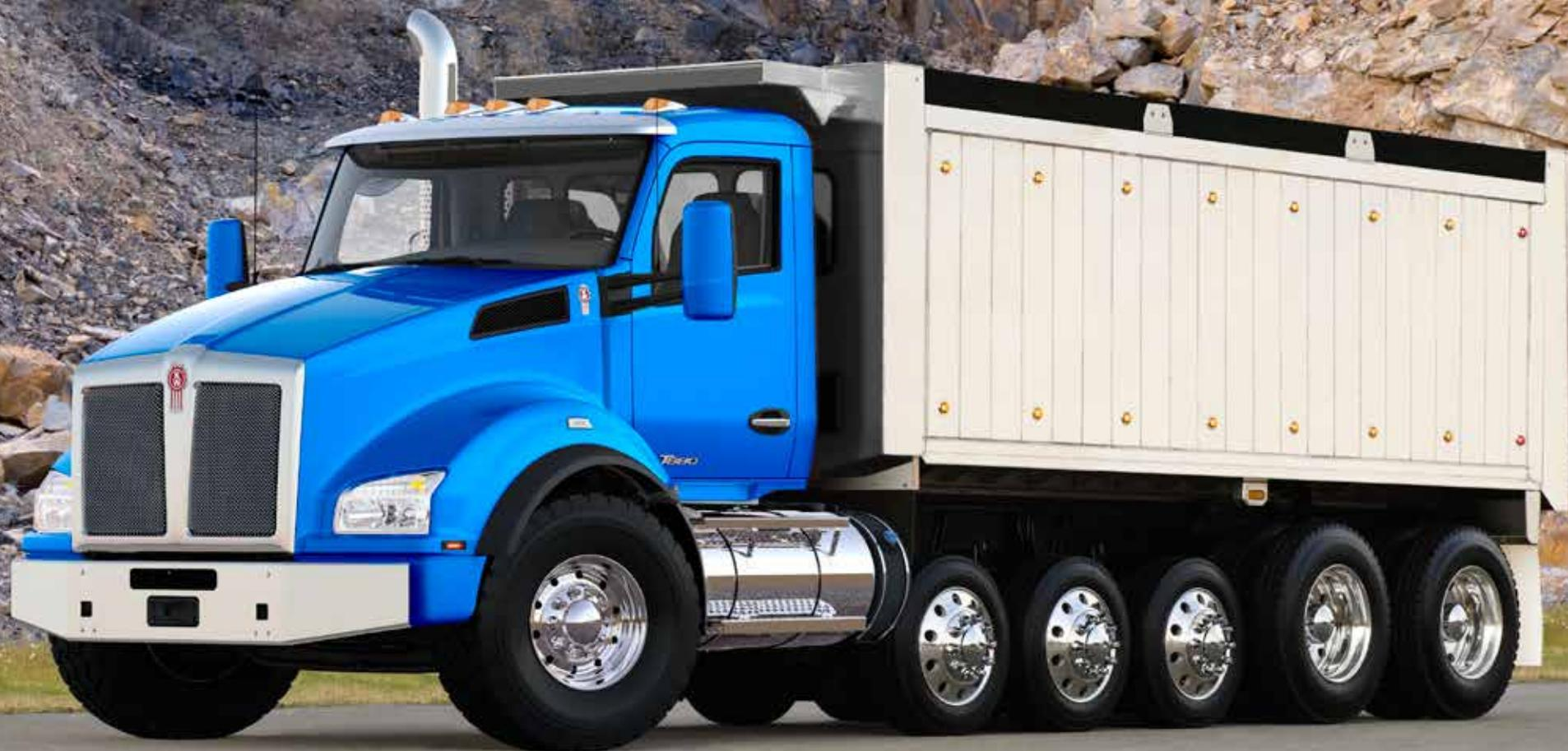
Camion à benne basculante T880 à six essieux
