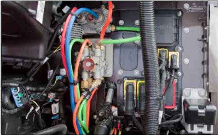
Le diagnostic des problèmes des systèmes pneumatique et électrique n'a jamais été plus facile. Une ouverture centralisée dans la paroi coupe-feu procure un accès immédiat. Ouvrez simplement le capot et tout se trouve au niveau des yeux.
