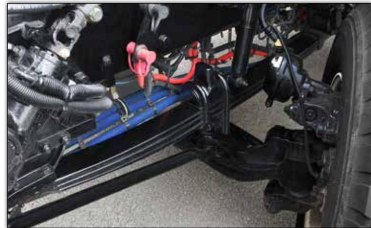
Les longs ressorts avant à lames dégressives Kenworth avec amortisseurs offrent une tenue de route en douceur avec une excellente stabilité. Disponibles sur le T880 dans une vaste gamme de rapports : de 5 443 kg à 9 979 kg.
