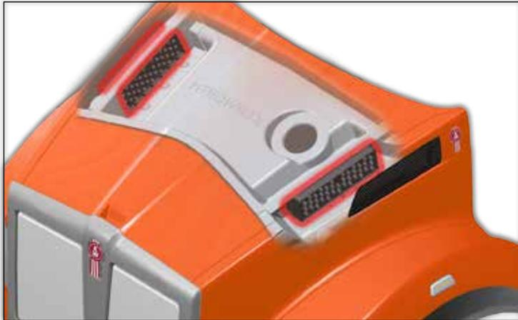
L'option pré-nettoyage constitue un ajout appréciable lorsque vous opérez dans des environnements poussiéreux tels les endroits restreints, les chantiers routiers ou les opérations de préparation de béton.
