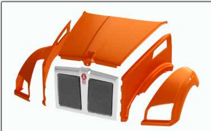
Fabriqué de Metton durable, le capot en 5 parties du T880 comporte des ailes boulonnées pour un remplacement rapide afin de vous permettre de retourner sur le chantier. Chaque aile peut être remplacée en moins de deux heures.
