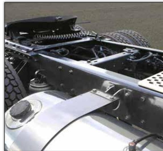
Le châssis d'un Kenworth est constitué d'une traverse droite monopièce fabriquée d'acier traité thermiquement – à perforations personnalisées selon les spécifications sans trous inutiles – offrant ainsi une force et une longévité supérieures.
