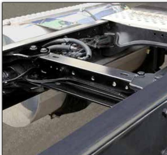
Des traverses en extrusion d'aluminium et des plaques de jonction en aluminium à 2 trous – faciles et non dispendieuses à remplacer – renforcent la structure du T880 sans ajouter beaucoup de poids supplémentaire. Toutes les composantes sont à ajustement libre pour une durée prolongée.
