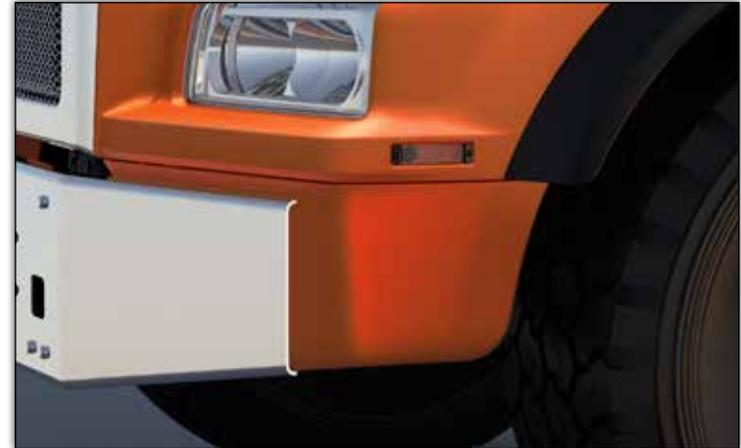
Oubliez la saleté, la boue et les éclaboussures grâce à l'accessoire optionnel de fermeture de l'aile avant de Kenworth, une brillante idée lorsque vous conduisez hors des sentiers battus ou avec de plus gros pneus.
