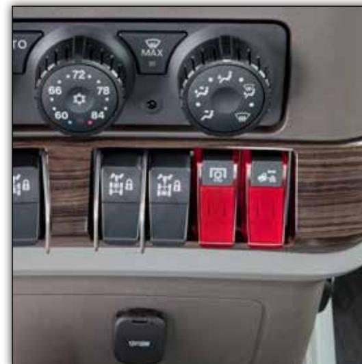
Les interrupteurs électriques, autrefois pneumatiques, du tableau de bord (remplaçant les soupapes à bascule du tableau de bord) procurent une fiabilité améliorée et éliminent les fuites d'air et le bruit dans la cabine. Une fonctionnalité additionnelle ainsi qu'une interaction du chauffeur sont maintenant possibles grâce aux nouveaux interrupteurs, ce qui génère un retour d'information par le biais du centre de performance du chauffeur dans le tableau de bord.
